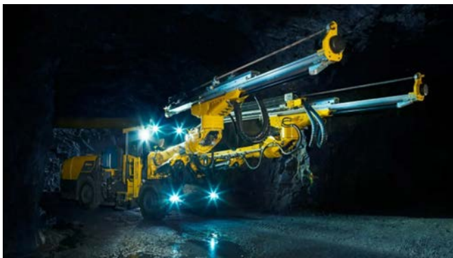
Boomer M20 S är en ortdrivningsrigg med en slanglös bomdesign som ger färre driftstopp, bättre sikt och högre förarkomfort – inklusive en tystare hytt. Den är den första riggen i sitt slag som kan borra delvis på batteridrift för renare och mer effektivare drift.
