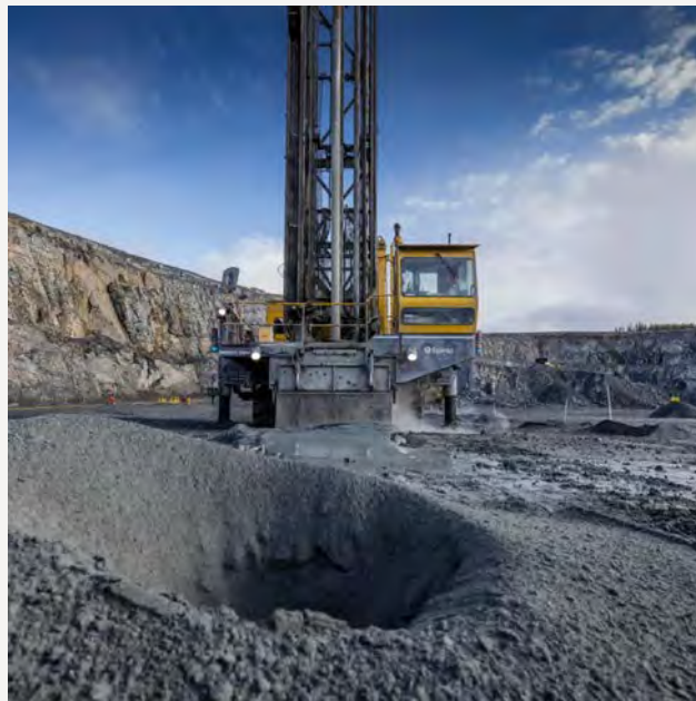
Vid Boliden Aitik i Sverige, Europas största koppargruva, arbetar Epirocs Pit Viper-borrriggar helt autonomt, vilket ökar säkerheten, förbättrar effektiviteten och minskar miljöpåverkan. Varje år borrar tusentals hål för att utvinna mer än 40 miljoner ton malm.
