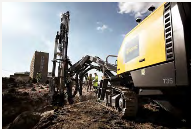
FlexiROC T35 R är en mångsidig ovanjordsbörigg för topphammarborming, byggd för krävande anläggnings- och täktarbeten. Med full radiostyrning och smarta designegenskaper som lång räckvidd på bommen, låg tyngdpunkt och hydrauliskt stödben klarar den även den tuffaste terrängen på ett säkert och effektivt sätt.
